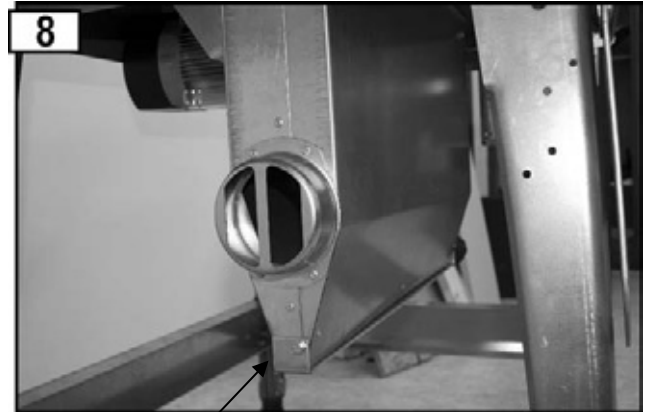
Spanauswurfschlitz geschlossen (Betrieb mit Späneabsaugvorrichtung)
