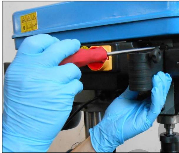
Figura 14 – Montaggio del blocco microinterruttore
