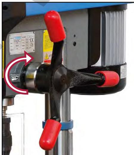
Figura 36 – Vite di blocco corsa mandrino.
