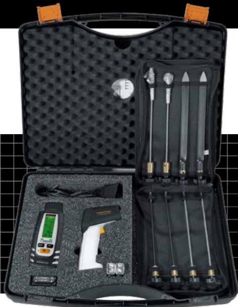
Set di ispezione universale per la valutazione della presenza di muffa e di danni causati dall'acqua
