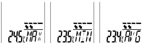
Le modalità Max/Min/Avg si riferiscono alla temperatura degli infrarossi e indicano rispettivamente la temperatura massima, minima o media degli infrarossi. I valori massimi, minimi e medi vengono determinati durante la misurazione in corso con il tasto di avvio premuto (9). Quando si avvia una nuova misurazione o premendo il tasto di avvio (9) il valore viene cancellato e calcolato di nuovo.
