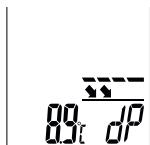
La temperatura del punto di rugiada è la temperatura al di sotto di cui si deve rimanere, affinché l'aria possa far precipitare il vapore acqueo sotto forma di goccioline, nebbia o rugiada. L'umidità da condensazione si forma, per esempio, quando una parete interna o un intradosso di finestra presentano una temperatura inferiore a quella di rugiada della stanza. Questi punti sono umidi e rappresentano un terreno di crescita per muffa oltre a causare danni al materiale.
