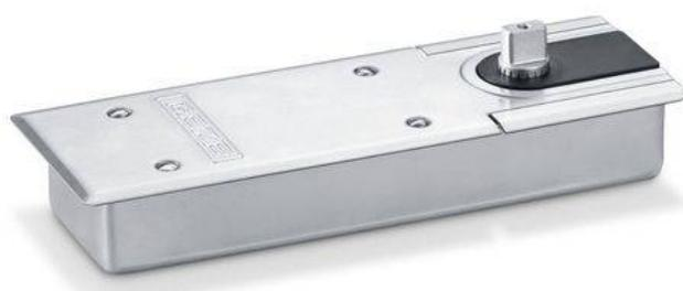
Chiudiporta a pavimento per porte a battente e pendolari a un'anta con larghezza dell'anta max. 1400 mm con forza di chiusura regolabile EN 3-6 e con blocco attivabile e disattivabile
