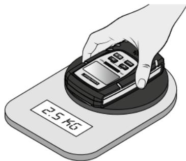
Appoggiare le superfici sensorizzate completamente sul materiale da misurare ed esercitare una pressione di ca. 2,5 kg sull'apparecchio.
