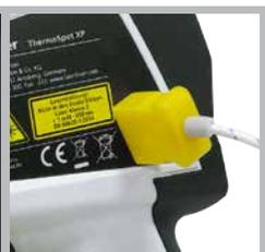
Collegamento per sensore termico di tipo K
