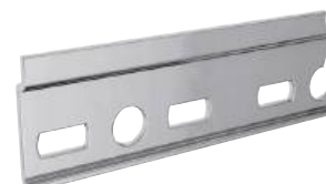
Barra reggipensile B3 Portata 2250N secondo normativa UNI 10768/99
