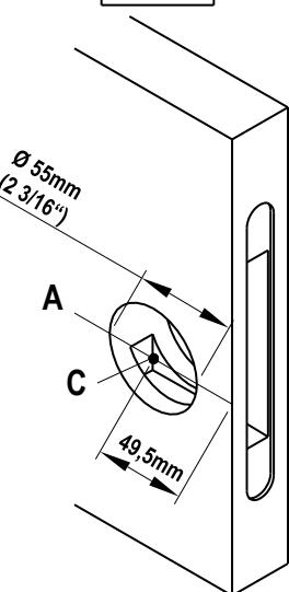
Fräsen Sie ein Loch (Ø55mm) halb durch die Tür von beiden Seiten um eine Beschädigung durch Splittern zu vermeiden.
