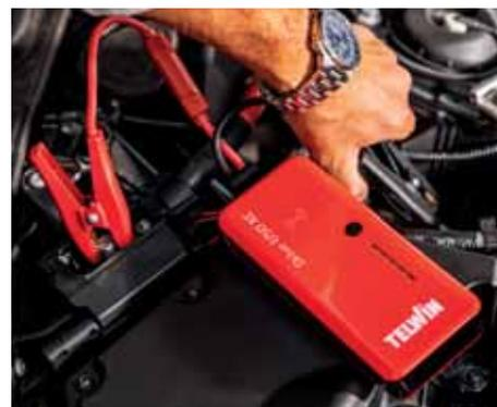
**3** Individua la batteria e collega prima la **pinza rossa (+)** al polo positivo, poi la pinza nera (-) al telaio o al polo negativo della batteria.
