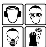
Tragen Sie geeignete persönliche Schutzausrüstungen: Gehörschutz, Schutzbrille, Staubmaske bei stauberzeugenden Arbeiten, Schutzhandschuhe beim Bearbeiten rauher Materialien und beim Werkzeugwechsel.
